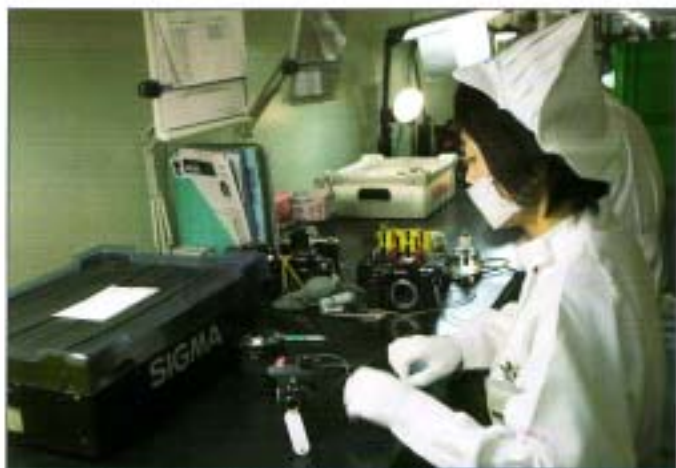
Zur Qualitätskontrolle gehört auch die Funktionsprüfung der Objektivs an den unterschiedlichen Kamerabajonetten.
