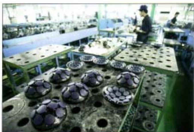
Vorbereitung der Linsen für den Schleifprozess.
