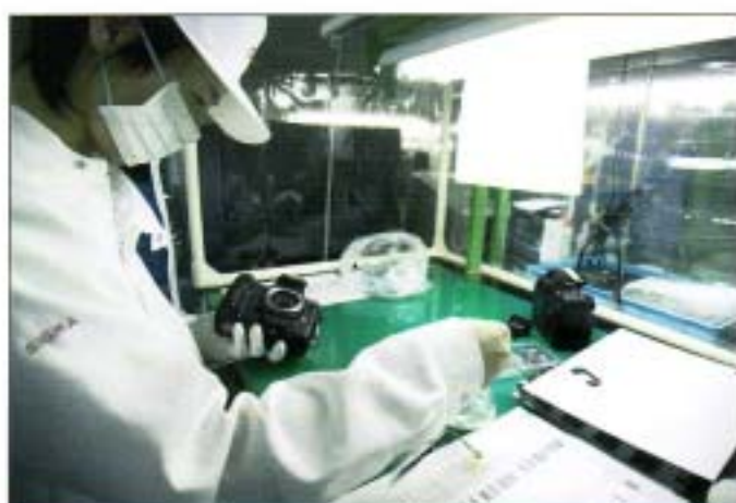
Endmontage der digitalen S010. Zu Anfang ist ein Produktion von 2.000 Stück pro Monat geplant.
